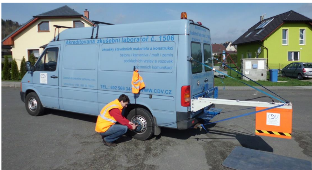
Obr. 3 Systém RoadScan pro měření při rychlostech za provozu – Horn antény 1,0 a 2,0 GHz umístěné za dodávkou Volkswagen s polohovacím zařízením
